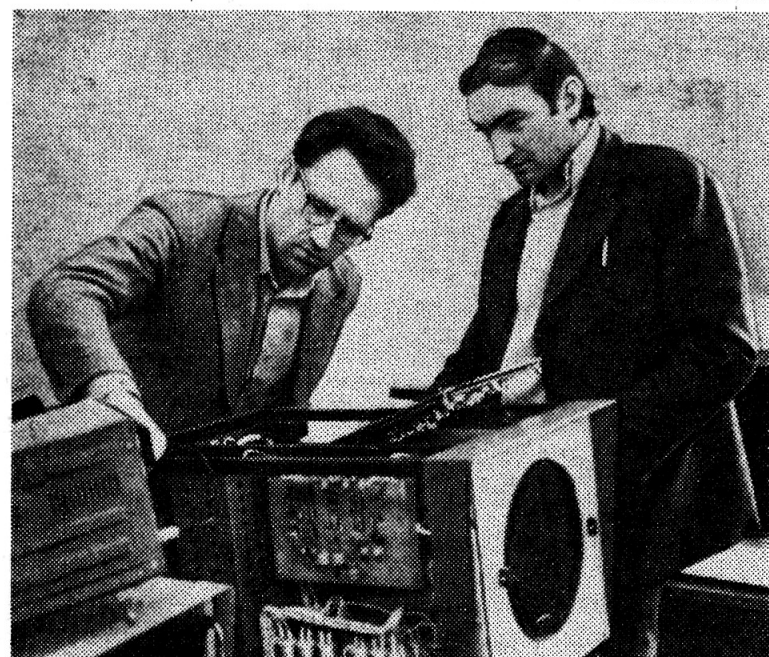
Старший инженер А. В. Никольников (слева) и научный сотрудник В. Ф. Левчановский за наладкой опытного образца графического дисплея на запоминающей электронно-лучевой трубке, выпуск которого в настоящее время налаживается на Опытном производстве ОИЯИ. Фото В. МАМОНОВА.
