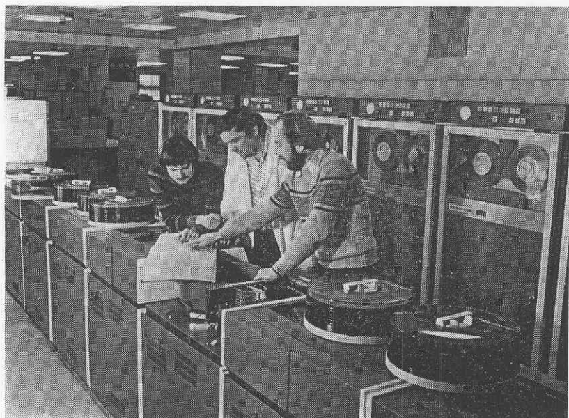
Инженеры предприятия РОБОТРОН Х.Р. Поль и Ю. Мёшк вместе с механиком Е. В. Рыжовым (в центре) выполняют юстировку дисковых накопителей на ЭВМ ЕС-1055М.
