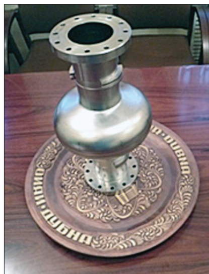
Один из резонаторов для ускорения электронов и позитронов в линейном коллайдере (для сравнения размещен на фирменной подарочной тарелке ОИЯИ).
