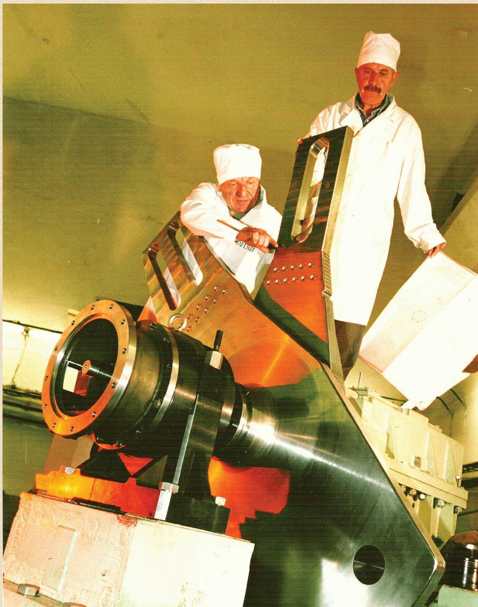
На стенде самого эффективного подвижного отражателя решетчатого типа.
