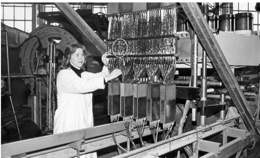
Лаборатория высоких энергий. Сцинтилляционный магнитный спектрометр для совместных ОИЯИ–МГУ исследований пространственно-временной структуры адронных взаимодействий
