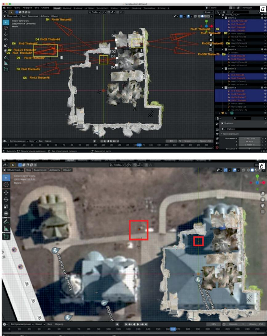
Рис. 27 (цветной в электронной версии). Полости, обнаруженные детекторами 2, 4, 5 и 6. а) Горизонтальная проекция подвала и части территории вблизи ЦПБМ. Найденные аномалии обозначены желтыми прямоугольниками. Точность определения центра правого прямоугольника (в подвале)  $\pm 1$  м и левого (между зданиями)  $\pm 2,5$  м. б) Та же область на объемном изображении с привязкой к местности (области обнаруженных аномалий обозначены красными прямоугольниками)
