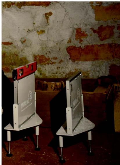
Рис. 4. Детекторы первой экспозиции, установленные в подвале ЦПБМ. Положение детекторов контролировалось по уровню
