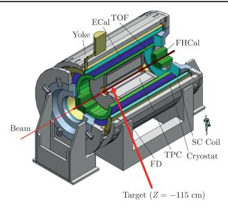
Рис. 1. Схема установки эксперимента MPD в режиме работы с фиксированной мишенью
