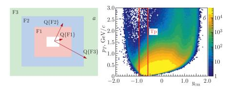
Рис. 2 (цветной в электронной версии). a) Схематическое изображение модулей переднего адронного калориметра (FHCal), разделенных на три подсобытия (F1, F2 и F3), обозначенных разными цветами. Стрелки обозначают Q-векторы каждого подсобытия. b0 Схематическое изображение кинематического окна (в плоскости  $p_T-y_{\rm cm}$ ) для дополнительного подсобытия из времяпроекционной камеры (TPC)
