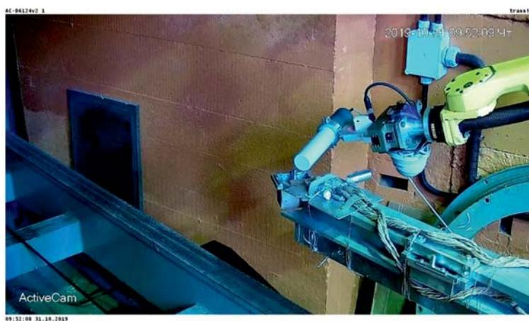
Рис. 4. Фото одной из камер системы видеонаблюдения, сделанное в момент измерения мощности дозы у поверхности образца
