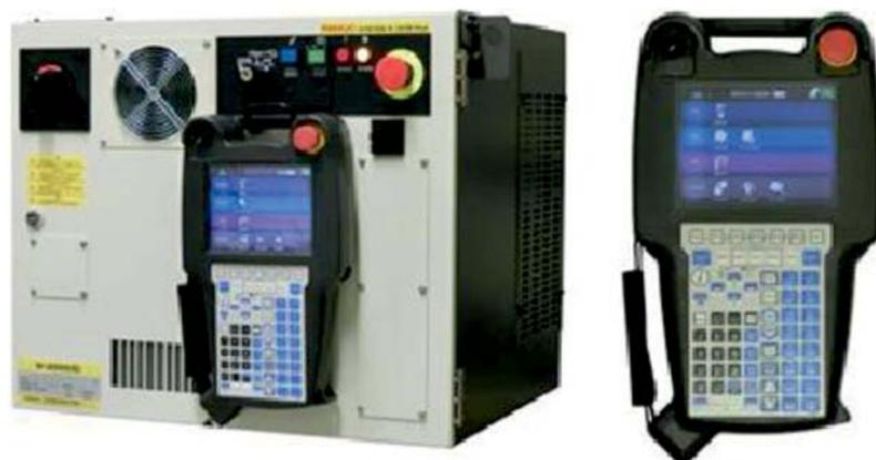
Рис. 3. Контроллер управления роботом и выносной пульт
