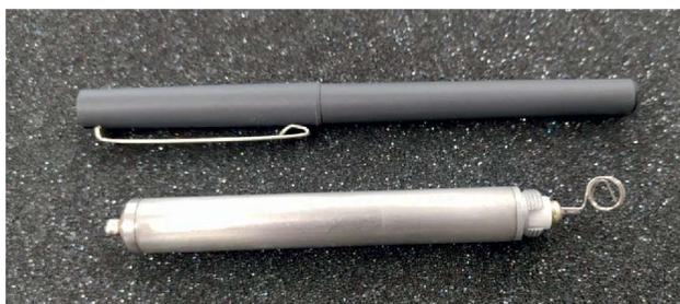
Рис. 6. Внешний вид гелиевого счетчика LND 25169
