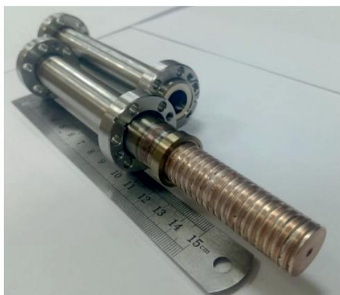
Рис. 7. Паяная миллиметровая структура, состоящая из 42 регулярных ячеек и 2 боковых ячеек, и второй комплект оснастки из нержавеющей стали
