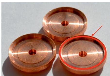
Рис. 6. Отдельные ячейки структуры перед пайкой, стрелкой показано место расположения припоя в одной из ячеек
