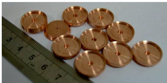
Рис. 5. Изготовленные регулярные ячейки структуры
