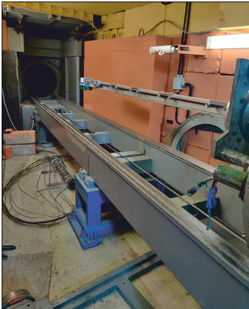
Рис. 4. Установка для облучения образцов с предустановленной конструкцией для исследуемой птеридофлоры перед началом облучения
