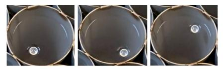
Рис. 19. Движение шарика по окружности с постоянной скоростью над спокойной поверхностью жидкого азота
